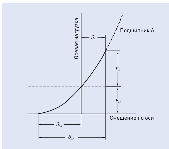
Рис. 4.8 Сравнение жесткости и преднатяга
