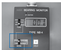
Записывание вибраций, вызванных царапиной внутри подшипника (ENVELOPE)
