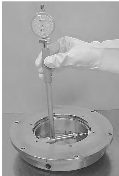
Рис. 1.11 Регулировка вписанного диаметра калибра GN
