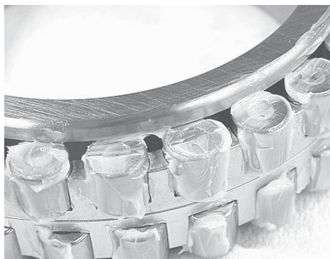
Рис. 1.20 Наполненный смазкой цилиндрический роликовый подшипник
